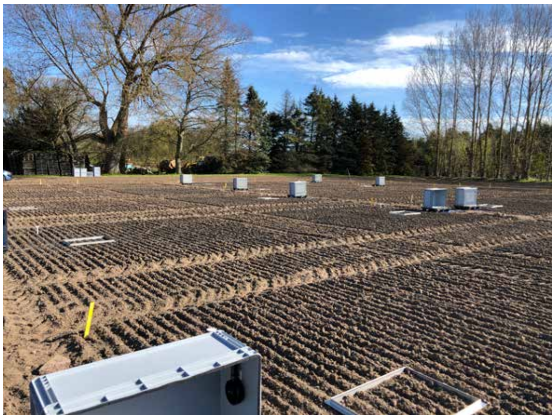
Udover målinger af plantevækst og kulstof-stabilitet måles også effekten af biokul på afgasning af drivhusgassen N_2O . Dette gøres ved hjælp af tætsluttende plastkamre, som placeres på stålrammer placeret i de forskellige forsøgsfelter.
