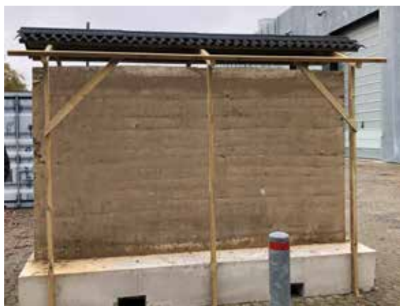
Demonstrationsmur opført af studerende i juli 2022, hvorefter den har stået udenfor. Sidste billede er fra januar 2023, og viser nødvendigheden af kalkstabilisering.
