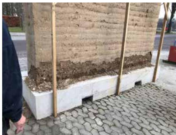
Demonstrationsmur opført af studerende i juli 2022, hvorefter den har stået udenfor. Sidste billede er fra januar 2023, og viser nødvendigheden af kalkstabilisering.
