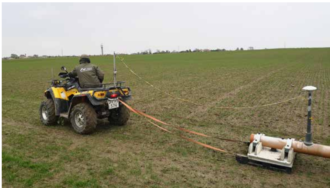
Måling af jordens egenskaber med en elektromagnetisk sensor.
