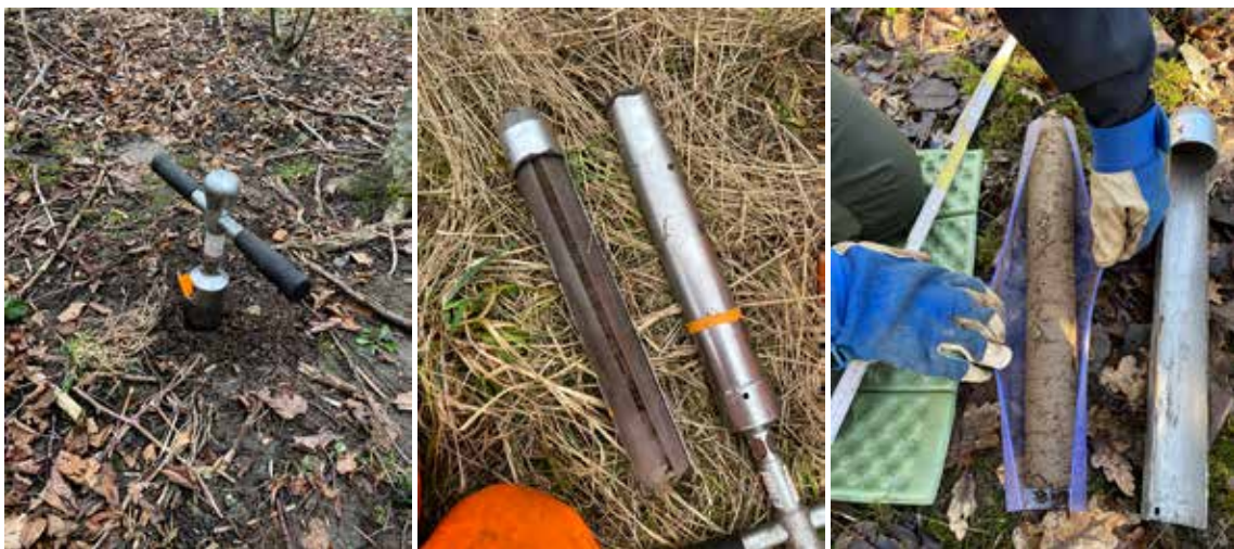
Fig. 2. Split tube soil auger. En type jordbor der deformerer jordsøjlen mindst muligt. Foto: Marie Louise la Cour Bergmann
