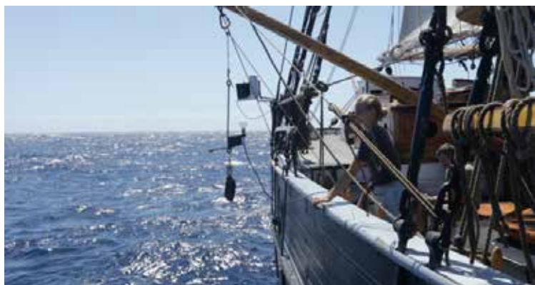
Daglig måling af PAR – mængden af sollys, der kan udnyttes af phytoplankton. Første måling foretages over overfladen, og derefter sænkes den ned i vandet og måler på hver tiende meter. Foto: Fabien Cauture
