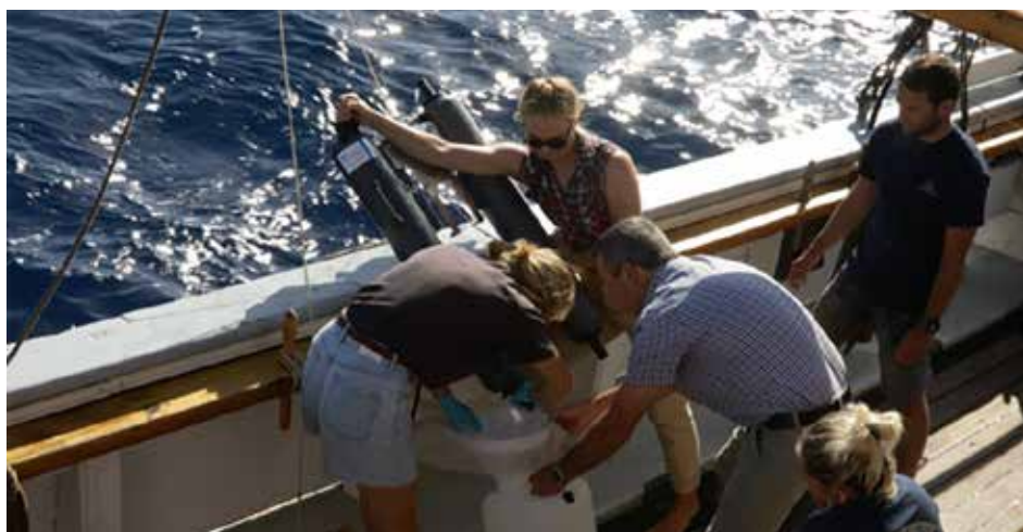
Vandprøve fra 100 meters dybde filtreres for zooplankton, inden det bruges til inkubationsforsøg. Før det er små vandprøver blevet taget fra og frosset ned, så de kan analyseres i laboratoriet senere. Foto: Jonas Bergsøe
