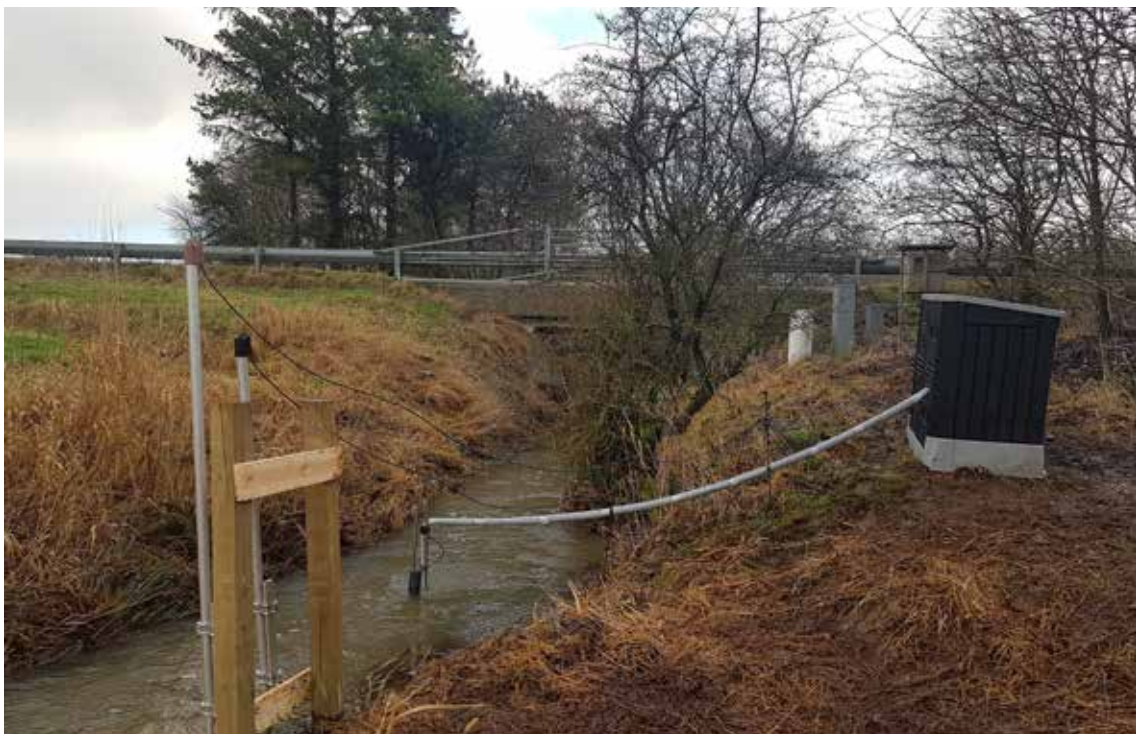
Måling af vandføring i Gudenåen ved brug af StreamPro og OTT MF Pro. Foto: S. van't Veen
