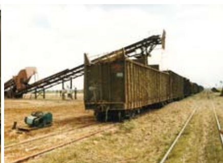
7. På læssestationen fyldes de tomme vogne vha. transportbåndet med friske, snittede sukkerrør fra de omkringliggende marker.
