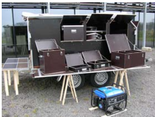
NaturBornholms mobile feltlaboratorium er bygget op på en buggy-trailer med mange rum til udstyr, kasser og kufferter.
