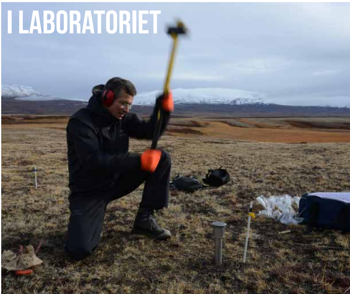
Fig. 1. Zackenberg i 2013 hvor en række permafrostkerner blev hjembragt for at undersøge, i hvilket omfang metan ( \text{CH}_4 ) produceret i nyoptøet permafrost kan iltes til kuldioxid ( \text{CO}_2 ) i den mere eller mindre iltrige overjord. Foto: Hanne H. Christiansen.
