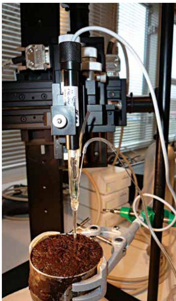
Fig. 3. En kerne fra lige under grænsen til permafrosten fra et vådbundsområde og senere brugt i en laboratorieopstilling med henblik på at måle diffusionen af lattergas produceret i kernen efter vådgøring. Foto: Bo Elberling.
