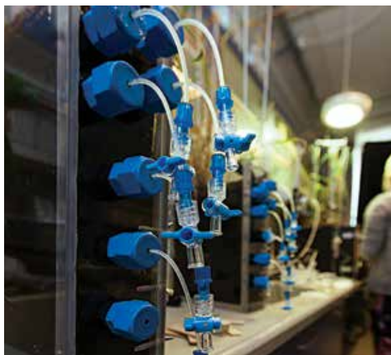
Fig. 4. Foto fra Zackenberg i 2012 hvor en række mesokosmer blev hjembragt for at studere, i hvilken omfang metan ( \text{CH}_4 ) produceret i nyoptøet permafrost kan iltes til kuldioxid ( \text{CO}_2 ) i den mere eller mindre iltrige overjord. Foto: Fra felten af Bo Elberling og fra laboratoriet af Kent Pørksen.
