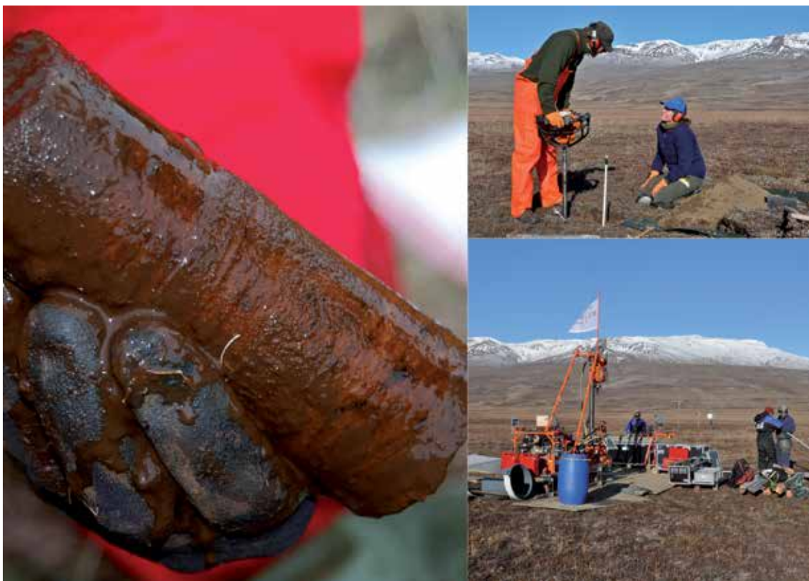
Fig. 2. Permafrostboringer. Den store borerig blev anvendt i Zackenberg i Nordøstgrønland i 2012. Den håndholdte borerig bruges på alle CENPERM sites og er velegnet til at tage kerneprøver i de øverste 3-4 meter.
