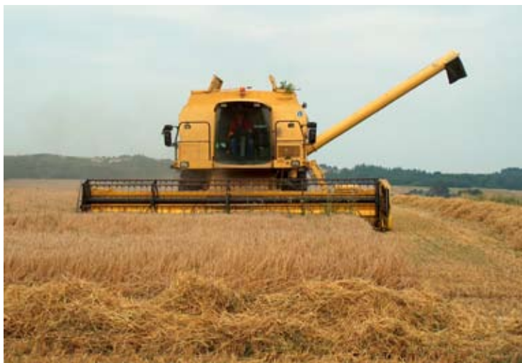
Furs største mejetærsker. En 24 fods mejetærsker kan på en enkelt time høste, tærske og rense lige så meget korn, som man med le, rive og plejl tidligere skulle bruge godt 300 arbejdsdage på.
