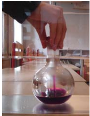
3. trin Nedsænkning i koldt vand; Bemærk at væskesøjlen falder.
