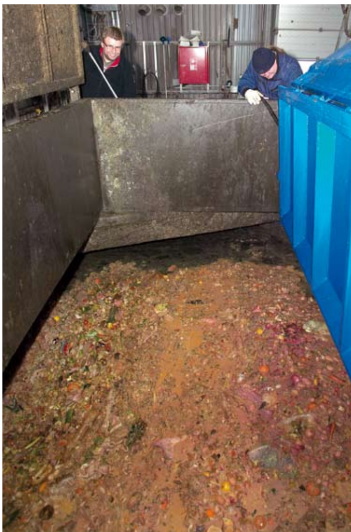
Blanding af gylle og industriaffald før det forvandles til biogas.
