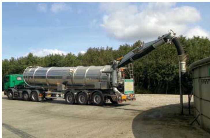
Fedtholdig industriaffald tilsættes gyllen for at forøge gasproduktionen.
