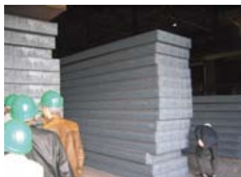
Stålbarrer, der stadig ER meget varme, vejer ca. 25 ton.
