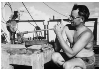
7. Prof. ZoBell med sit trykapparat. De små glastuber med bakterier i forgrunden anbringes i stålcyliner t.h., hvori de underkastes et tryk på 1.000 atm. Foto: Peter Rasmussen.
