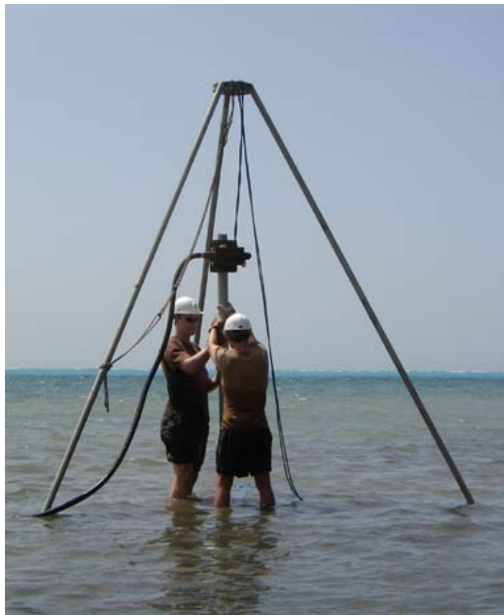
Figur 3. Vibra-coring. En betonvibrator fastspændt øverst på et 6 m langt aluminiumrør overfører vibrationerne til rørets spids, der ved tyngdekraftens hjælp synker ned. På billedet er røret knap 4 m nede i sedimentet.
